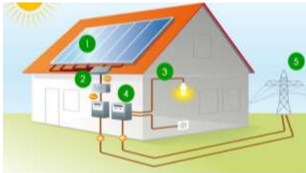
Նկ. 1. Ցանցային արևային էլեկտրակայանի համակարգի սխեմատիկ պատկեր
