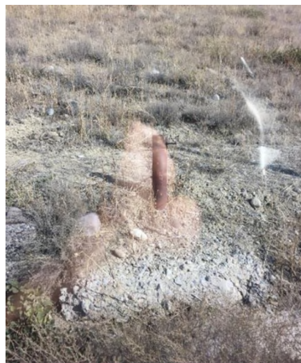
Նկ. 2. Պատվարի մարմնում տեղադրված այեզոմետրի արտաքին տեսքը
